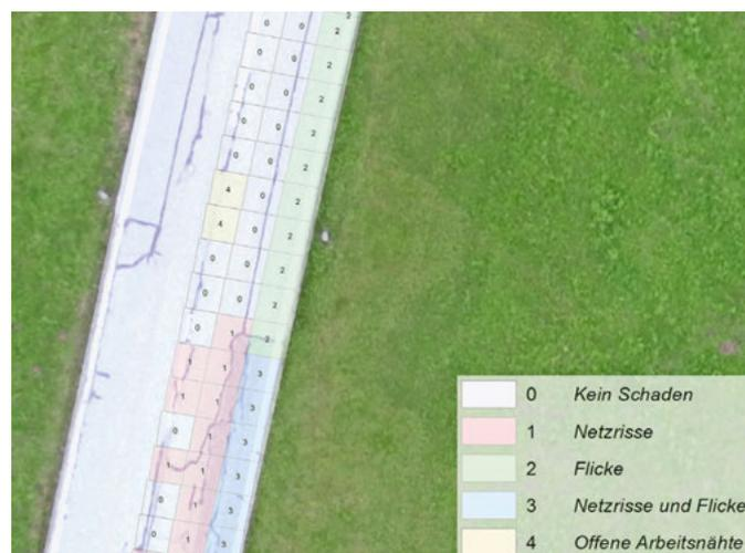
5 | Auswertung des Orthofotos von der Teststrecke nach deutscher Methodik mit gerasterter Fahrbahn und den vorgefundenen Schadensmerkmalen (in Deutschland Zustandsmerkmale genannt).
