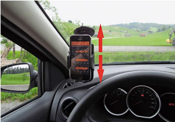
6 | Für Beschleunigungsmessungen befestigtes Smartphone an der Frontscheibe des verwendeten Fahrzeuges mit rot dargestellter Messrichtung.
